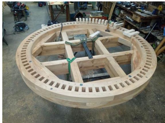
Hier sind schon einige Kämme in das Kammrad eingesetzt worden.
