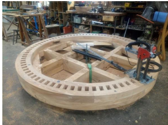
Die Öffnungen für die Radkämme werden mit einer speziellen Kettensäge eingefräst.
