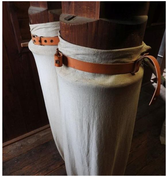
Absackvorrichtung: Früher wurde das Mehl in 75- oder 100 kg-Säcken ausgeliefert.
