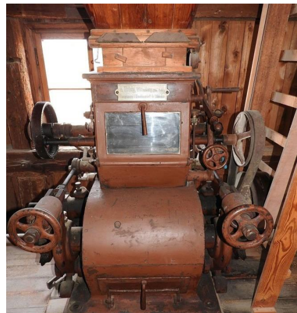
Walzenmahlstuhl der Firma A. Wetzig aus Wittenberge
