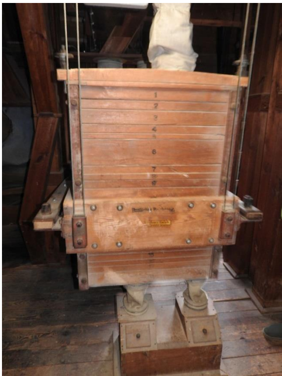
Beim diesem Plansichter werden die horizontal angeordneten Siebe durch einen Exzenter bewegt.
