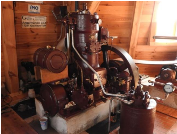
Der Dieselmotor vom Typ KZ26 von den Deutschen Werken Kiel nach der Restaurierung. Er leistet 22 PS bei 425 u/min. Der Motor wurde mit Hilfe einiger Firmen aus der Uckermark restauriert und ist heute wieder lauffähig. 15
